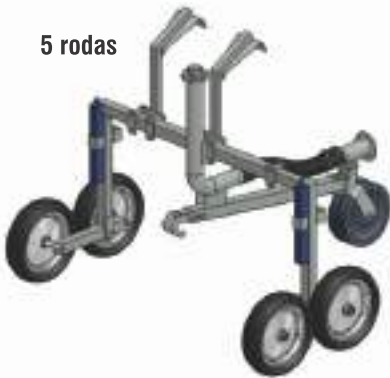
Rodas traseiras com eixo tandem
